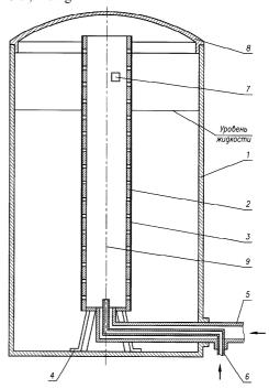
Изобретение относится к противопожарной безопасности и предназначено, преимущественно, для тушения пожаров в резервуарах с жидкими горючими веществами.
